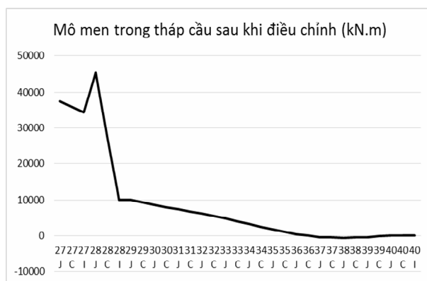
Hình 11. Mô men trong tháp cầu trước và sau khi điều chỉnh nội lực
