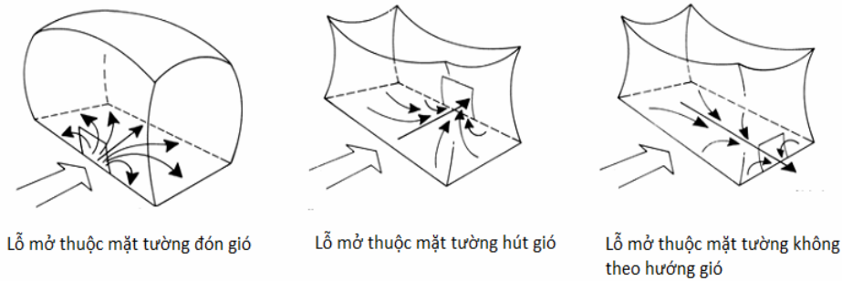
Hình 3. Ảnh hưởng của vị trí ô mở đến hệ số áp lực bên trong [7]
