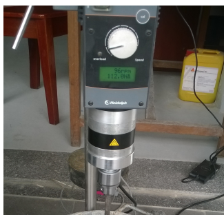
Hình 1. Bộ dụng cụ thí nghiệm đo ma sát tiếp xúc giữa bê tông tươi và mặt ống thép (tại phòng thí nghiệm Xây dựng, Đại học Duy Tân). (a) Đầu khuấy cơ-điện. (b) Xi lanh quay và thùng chứa, bê tông được đổ vừa tiếp xúc mặt đáy bình. (c) Bình chứa đầy bê tông và xi lanh quay trong bê tông.
