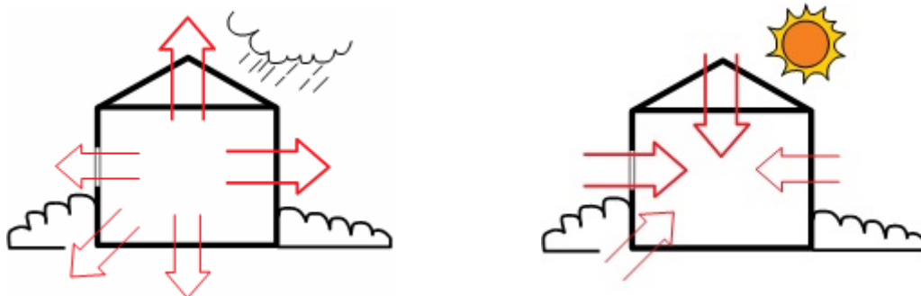
Hình 1. Mô hình mất nhiệt vào mùa đông và thu nhiệt vào mùa hè của tòa nhà
