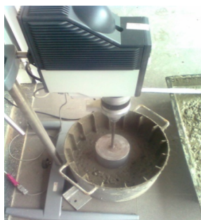
Hình 1. Bộ dụng cụ thí nghiệm đo ma sát tiếp xúc giữa bê tông tươi và mặt ống thép (tại phòng thí nghiệm Xây dựng, Đại học Duy Tân). (a) Đầu khuấy cơ-điện. (b) Xi lanh quay và thùng chứa, bê tông được đổ vừa tiếp xúc mặt đáy bình. (c) Bình chứa đầy bê tông và xi lanh quay trong bê tông.
