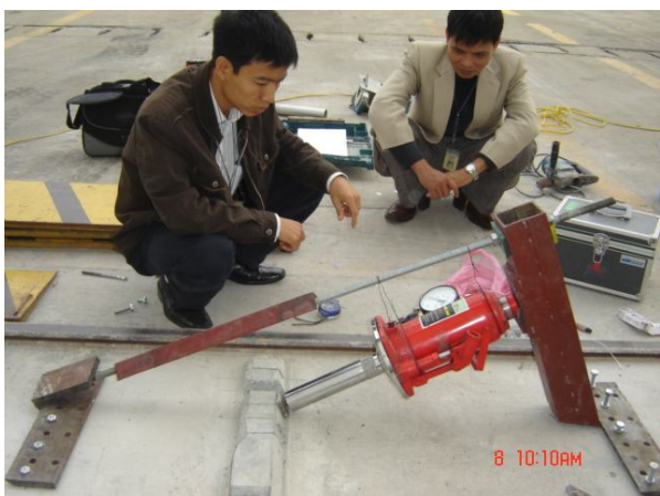
Hình 3. Thí nghiệm cường độ kháng trượt
