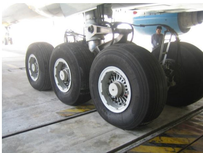
Hình 5. Kiểm tra bằng máy bay Boeing 777-200 ER (tải trọng 200T) đi qua vùng bê tông thử nghiệm
