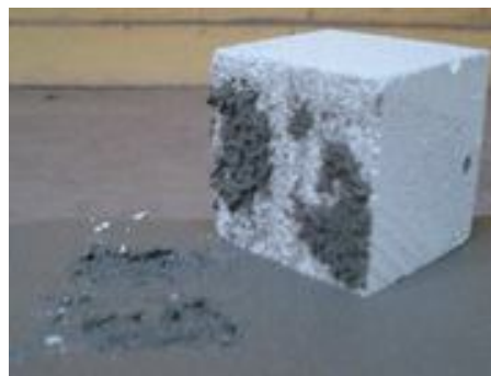
Hình 1. Thí nghiệm kiểm tra thời gian hiệu chỉnh a. Bề mặt tiếp xúc mẫu AAC lập phương cạnh 50mm sau 2 phút; b. Bề mặt tiếp xúc sau 6 phút
