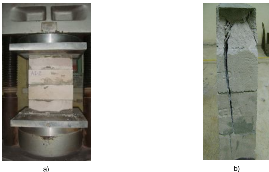
Hình 1. Thí nghiệm cường độ chịu nén của khối xây a) Bố trí thí nghiệm b) Dạng phá hoại khối xây
