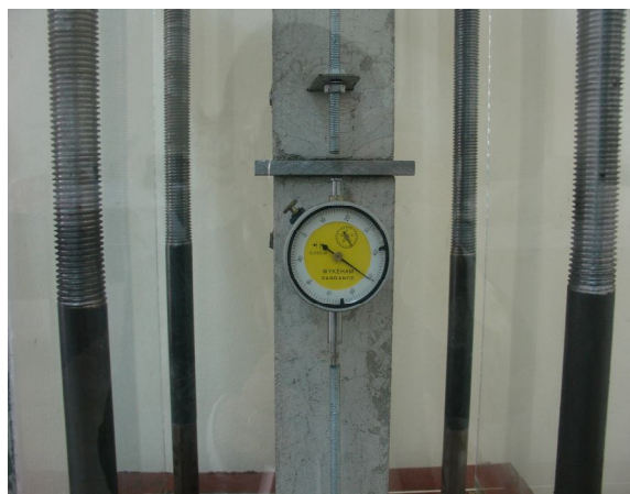
Hình 2. Đồng hồ đo biến dạng có độ chính xác 0,002 mm
