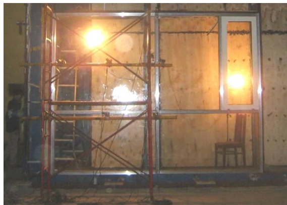
c) Thí nghiệm mặt dựng tường kính của công trình tòa nhà trụ sở hải quan (Hà Nội)
