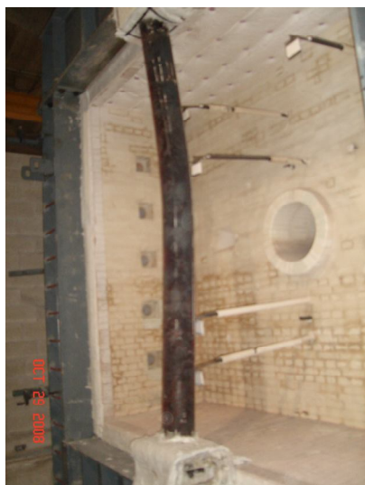
Hình 3. Cột 1B sau thí nghiệm
