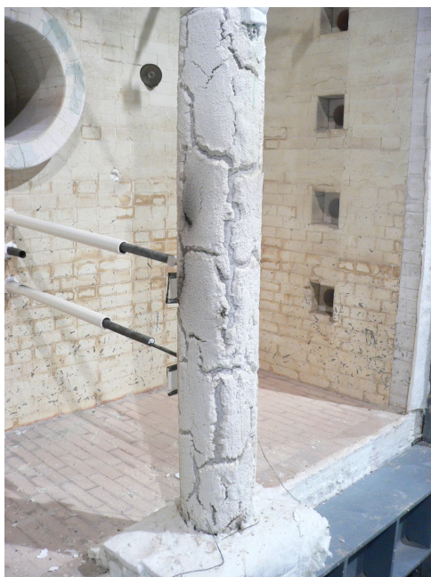
Hình 5. Cột 3B với lớp sơn chống cháy sau khi thí nghiệm
