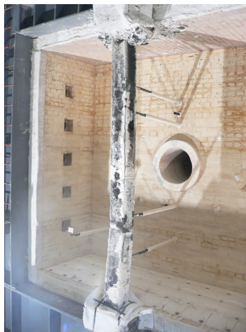
Hình 6. Cột 4B sau thí nghiệm
