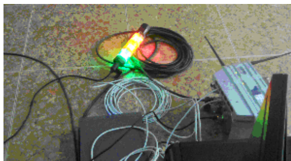
Hình 8. Đèn báo động khi dịch chuyển vượt quá giới hạn cho phép
