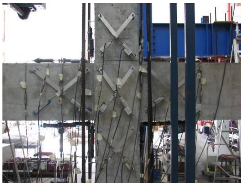
Hình 5. Sơ đồ bố trí dụng cụ đo góc xoay và biến dạng cốt
