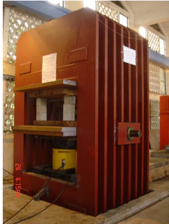
Hình 4. Thí nghiệm thử tải gối đỡ dầm mái nhà chính Trung tâm Hội nghị Quốc gia (NCC)
