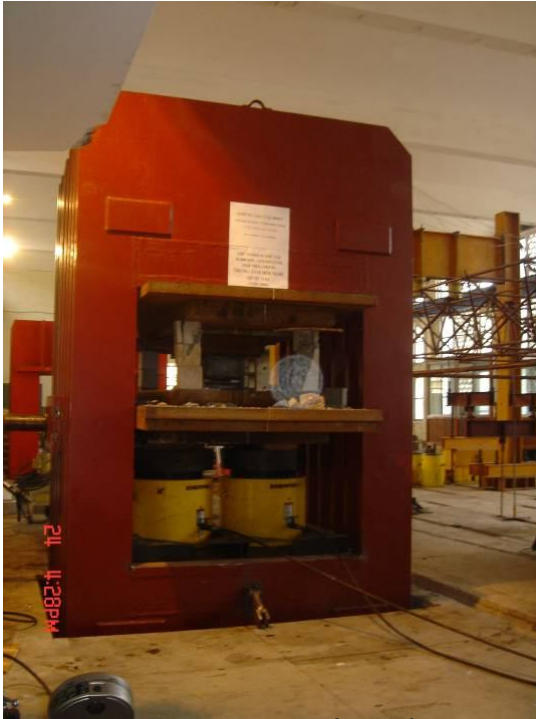
Hình 4. Thí nghiệm thử tải gối đỡ dầm mái nhà chính Trung tâm Hội nghị Quốc gia (NCC)
