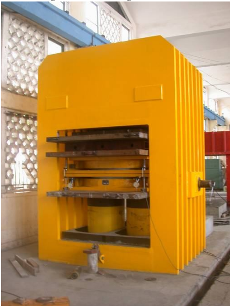
Hình 5. Thí nghiệm thử tải gối chấu công trình cầu Rạch Miễu, Quốc lộ 60 – Bến Tre
