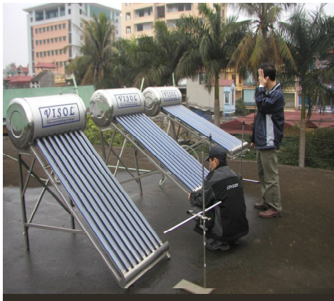
Cấp nước đơn lẻ bộ thu nhiệt và ống chân không liền khối
