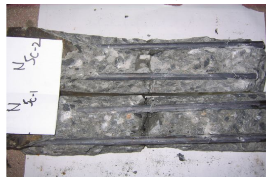
Hình 6. Bề mặt cốt thép mẫu N_{5c}
