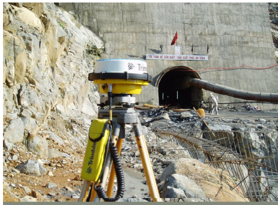
Hình 2. Máy thu tín hiệu vệ tinh GPS TRIMBLE4600-LS
