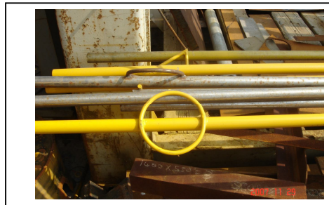
Hình 8. Các tiêu ngắm để quan trắc lún bề mặt bằng đo cao lượng giác
