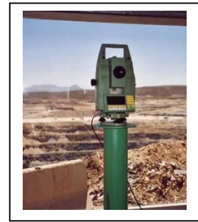
Hình 7. Cầu dẫn của cảng xuất sản phẩm và bộ đặt máy để quan trắc lún
