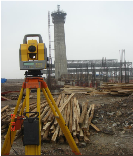
Hình 1. Sử dụng máy toàn đạc điện tử (TĐĐT) để kiểm soát độ nghiêng công trình
