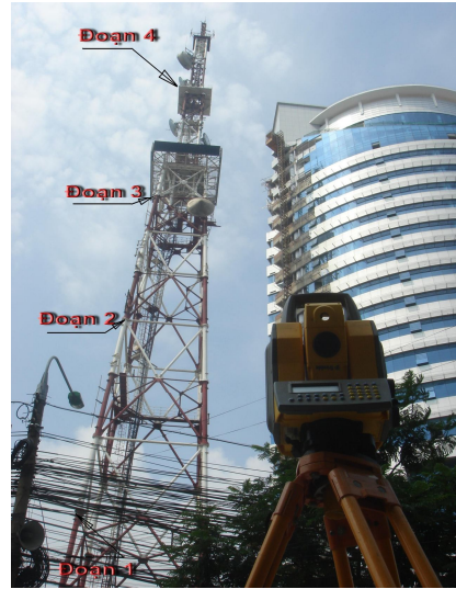
Hình 1. Sử dụng máy toàn đạc điện tử (TĐĐT) để kiểm soát độ nghiêng công trình
