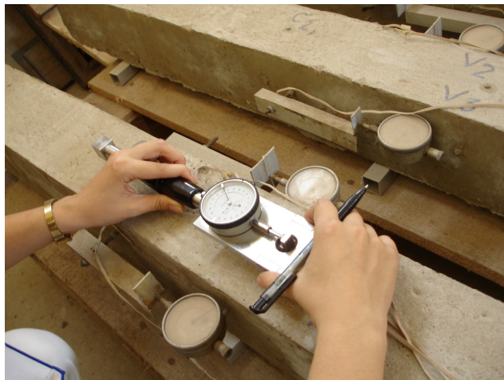
Hình 4. Đo biến dạng bằng đồng hồ và Comparator
