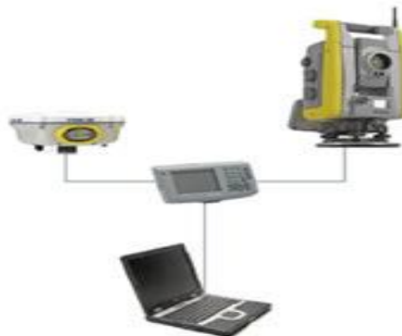
Hình 2. Kết hợp giữa máy S6 với máy GPS và Máy tính
