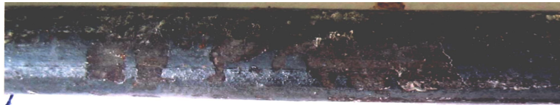
Hình 9. Bề mặt cốt thép trong vùng bê tông ẩm và ướt sau khi phá mẫu
